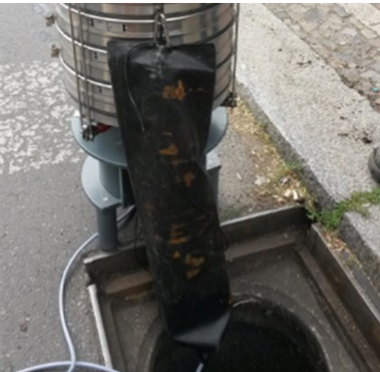
Probenahmekorb zur Beprobung von Straßenkehricht.
