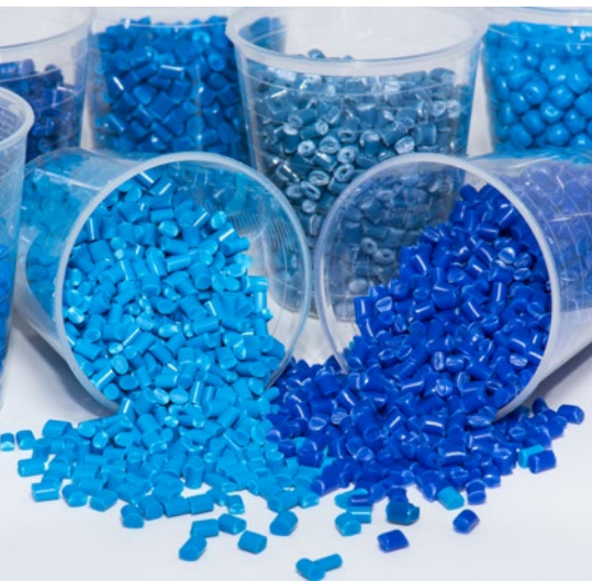
Granulate oder Pellets sind leicht schüttbare Partikel in der Größe weniger Millimeter.
