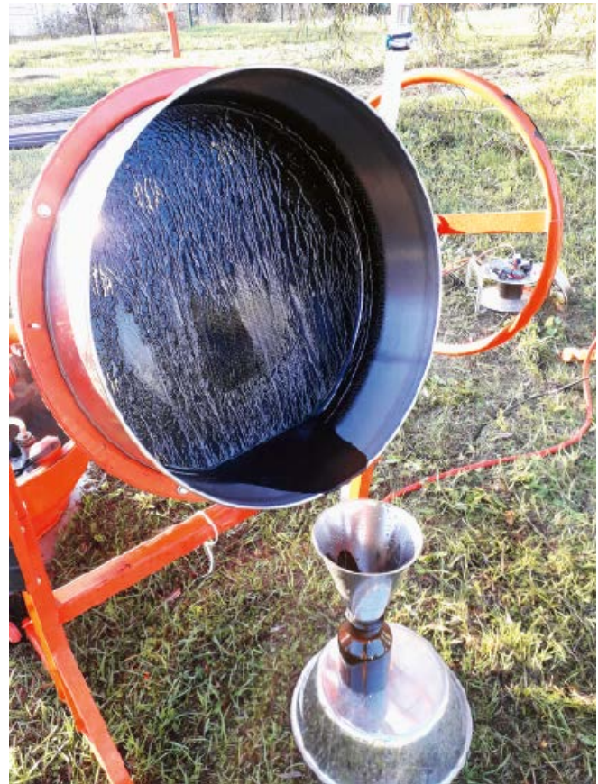
Abb. 2: Probenahmeapparatur mit rotierendem Sieb („RoSi“) aus 10- \mu m-Tressengewebe (Bild: TU Berlin)
